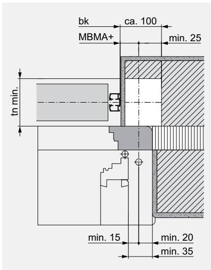
**Horizontalschnitt für Gelenkkurbeltrieb**
