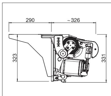
Montage sous dalle avec équerre de fixation
