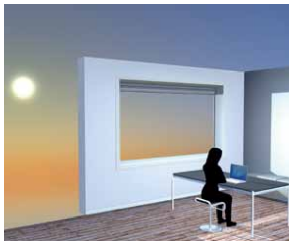
Hiver: des volets roulants montés au maximum veillent à un apport de chaleur naturelle- Le soleil d'hiver plus doux est bien moins éblouissant.
