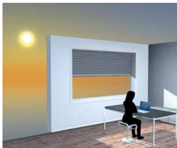
Printemps/automne: le soleil étant plus bas, les volets roulants sont davantage baissés pour un éclairage optimal au poste de travail.
